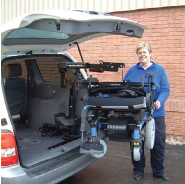
Figure 3. Des appareils de levage des aides à la mobilité peuvent être installés dans différents véhicules. Les véhicules et les appareils de levage doivent être adaptés aux dimensions des aides à la mobilité.
