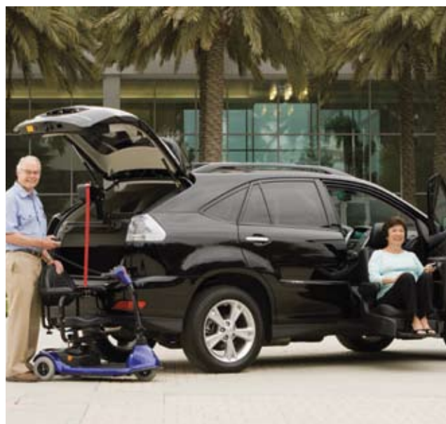
Figure 2. Un siège et une base adaptés peuvent être ajoutés à certains véhicules pour permettre au passager de faire un transfert par glissement ou en faisant un pivot en station debout. Un appareil de levage peut être installé pour soulever un triporteur ou un fauteuil roulant.
