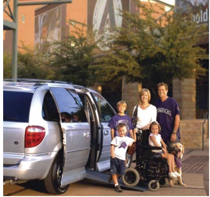
Figure 4. Une mini-fourgonnette dont le plancher a été abaissé permet d'augmenter l'ouverture de la porte et la hauteur de l'intérieur de la mini-fourgonnette; ainsi, les occupants en fauteuil roulant peuvent entrer plus facilement dans le véhicule et être assis confortablement dans leur fauteuil roulant.
