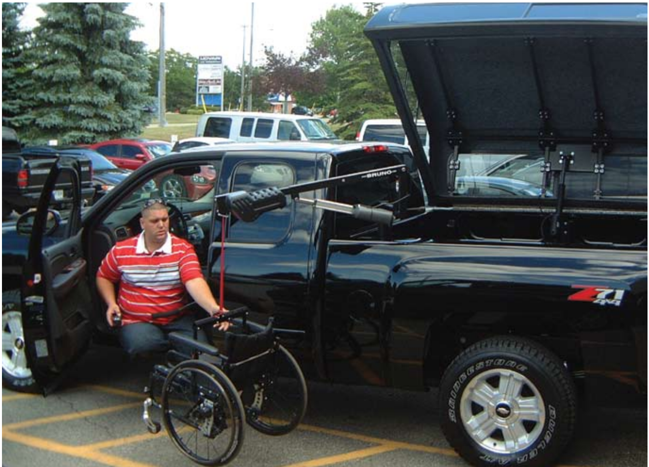
Figure 5. La conversion d'une camionnette permet de transporter une aide à la mobilité dans la boîte de la camionnette et de faire le transfert du fauteuil roulant à l'aide d'un dispositif d'appoint pivotant ou d'un appareil de levage.
