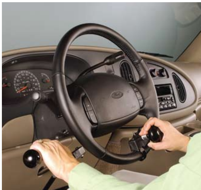
Figure 1. Des commandes manuelles mécaniques permettent à une personne d'actionner la pédale d'accélération et la pédale de frein sans l'aide de ses jambes et ce, dans presque tous les véhicules. Les commandes manuelles sont généralement combinées à une poignée de volant (boule au volant) qui offre une meilleure préhension pendant les virages à vitesse réduite.
